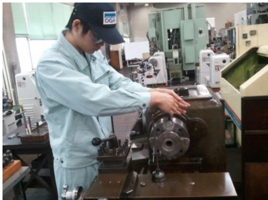
図 2. 段差加工
