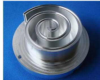
図 3. 牧野フライス製作所 可動側スクロール加工例
