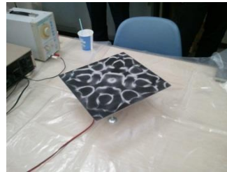
図 4. 機械振動デモ (グラトニ図形)
