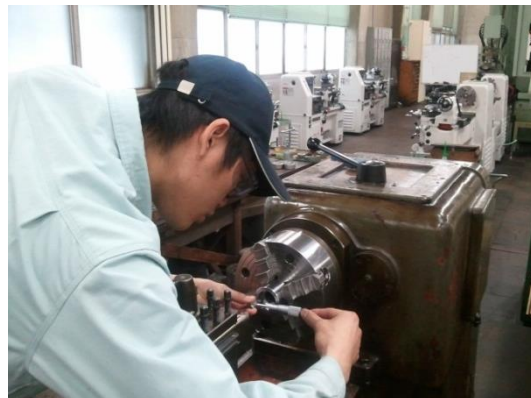
図 3. 外径測定
